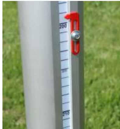
analogowa skala wysokości nadrukowana na pasku zębatym z kalibrowaną strzałką
