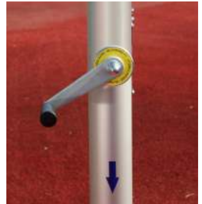
Kurbelmechanismus mit Bremse, die ungewolltes Verstellen verhindert.
