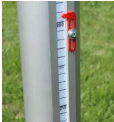
Analoge Höhenskala auf einem Zahnriemen mit kalibrierbarer Ablesemarkierung
