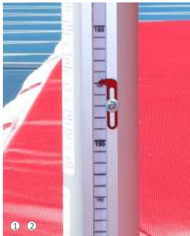
① ② Analoge Höhenskala auf einem Zahnriemen mit kalibrierbarer Ablesemarkierung für den Notfall.
