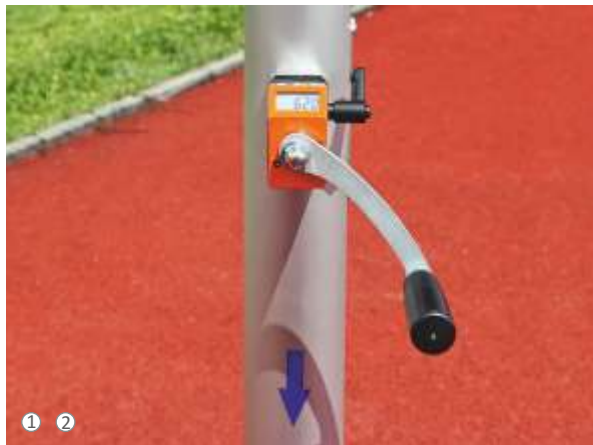
① ② Die Ständer sind mit elektronischen Höhenanzeigern ausgerüstet und kommen ohne traditionelles Messband aus. Die Elektronik ist in einem wetterfesten Gehäuse untergebracht und mit einer Edelstahlkurbel ausgestattet. Feuchtigkeit, hohe Temperaturen und UV-Strahlung können dem Gehäuse nichts anhaben. Batterie-lebensdauer: mindestens fünf Jahre.
